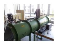
Das Ziel dieses Versuchs ist die Aufnahme des Kennfeldes eines Axialgebläses durch die Variation des Volumenstroms. Der Wirkungsgrad des Axialgebläses soll bestimmt werden.
